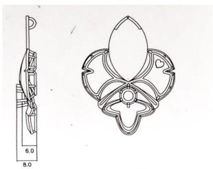
Материал: латунь Пластина 1.0мм: 45\*70мм Квадрат. проволока 1.0мм: 60мм Круг. проволока 1.0мм: 330мм
