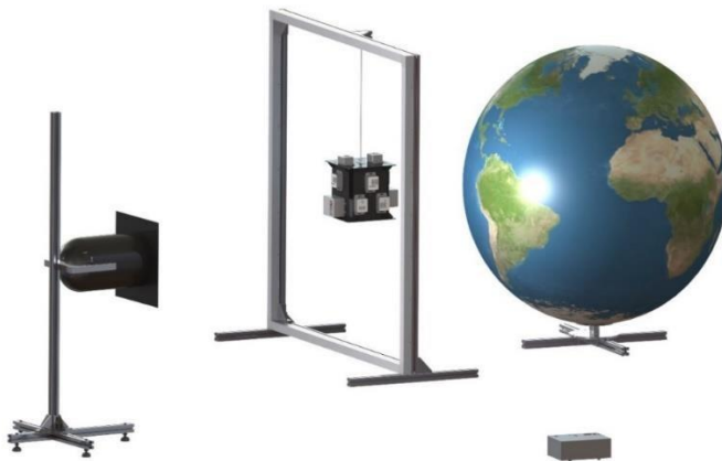
Рис. 4. Магнитная рамка (имитатор магнитного поля Земли) с подвесом, имитатор Земли, имитатор Солнца
