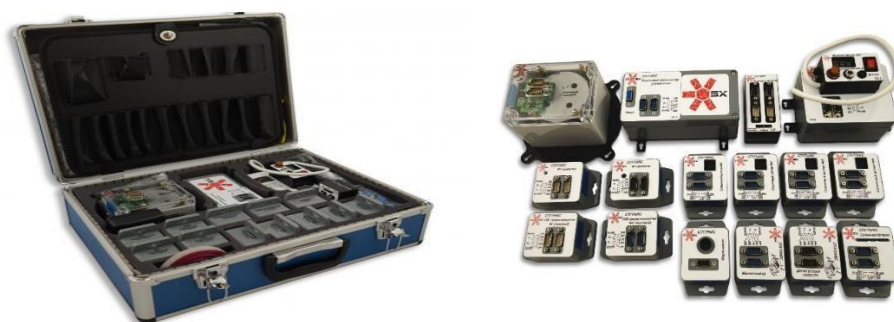
Рис. 1. Общий вид собранного конструктора «ОрбиКрафт»
